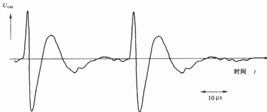
图 E1. b 带宽 \Delta f=45\text{ kHz}\sim 440\text{ kHz} , 长时输入脉冲
